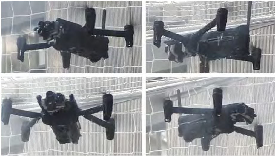
Fig. 6: IPX3 testi (dakikada 10 litre püskürtme)
