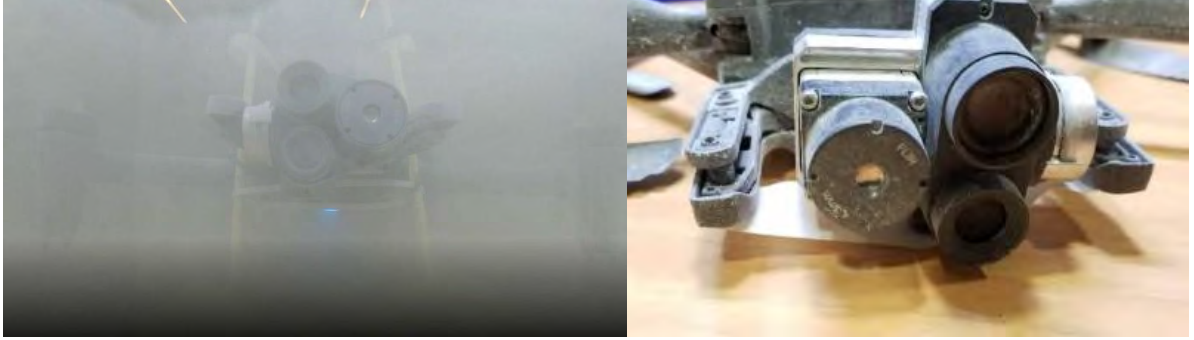
Fig. 7: IP5X testi (kum)
